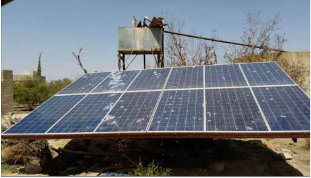
الألواح الشمسية التي أصابها هجوم 22 فبراير/شباط في قحزة بمحافظة صعدة. يدل هذا الأثر على إصابتها بذخائر عنقودية صغيرة كالتى نطلقها الذخائر العنقودية. © 2017Private
